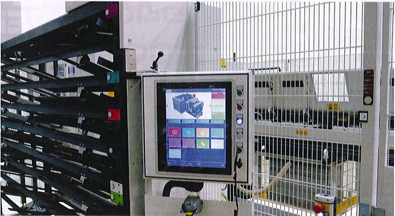
Die Zuführzelle für die Rohre mit Bedieneinheit.
